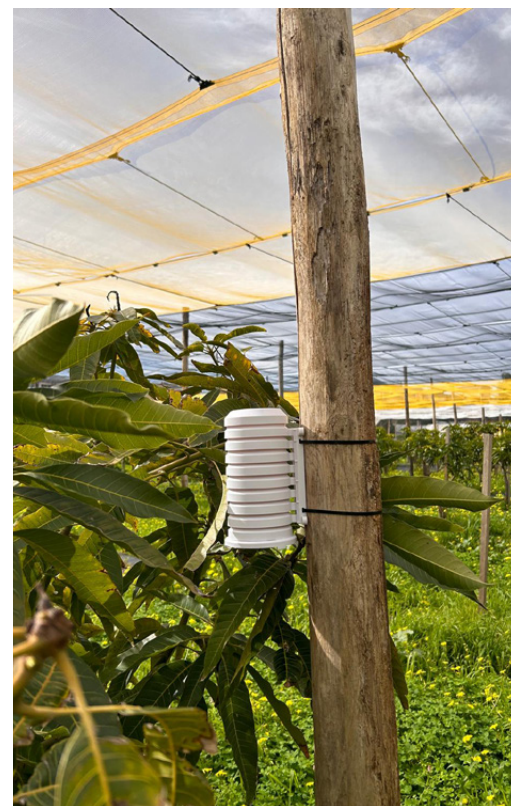
Sensore di Temperatura e Umidità sotto rete
